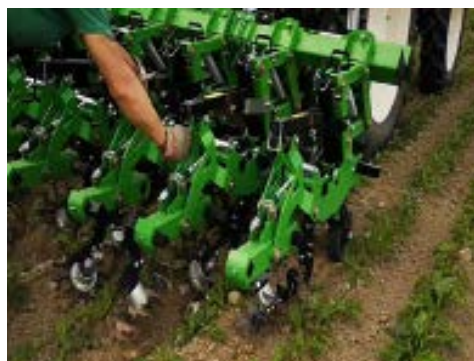
4. Particolare di sarchiatrica dotata di organi di lavoro che interagiscono con le file di bietole coltivate.
